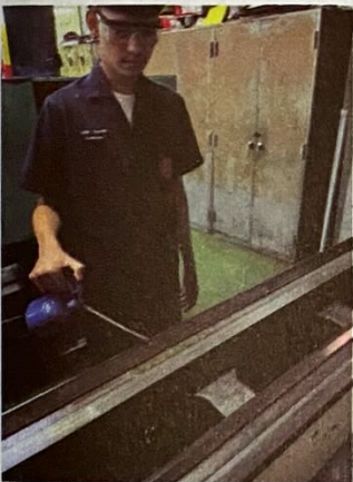
รูปที่ 4.46 หยอดน้ำมันในส่วนที่ต้องหล่อลื่น
