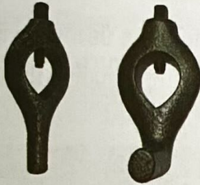
รูปที่ 4.26 ห่วงพาแบบต่าง ๆ และการใช้งาน
