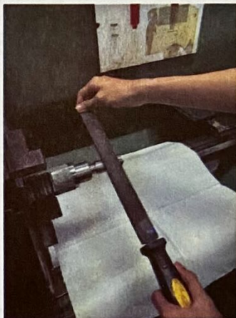
รูปที่ 4.48 ขณะตะไบ ขัดชิ้นงาน หรือเลื่อยงาน ต้องมีผ้าหรือกระดาษรองรับเศษโลหะ
