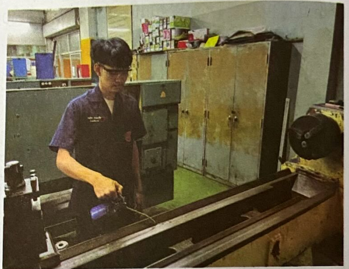
รูปที่ 4.51 แทนเลื่อนหลังเลิกใช้งานให้เลื่อนไปท้ายแท่น พร้อมทำความสะอาด หยอดน้ำมัน
