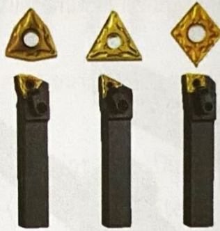
รูปที่ 4.30 ด้ามจับมีดเล็บ (Carbide Insert Tool Holder)
