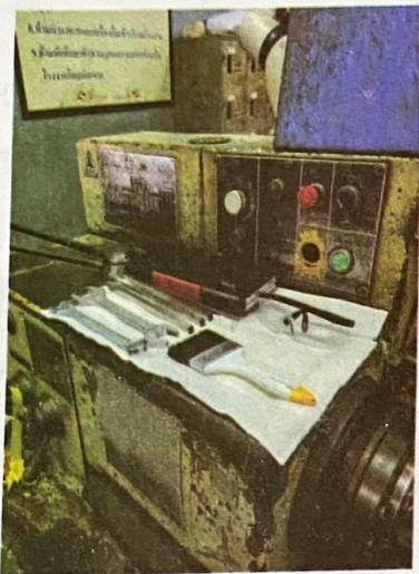
รูปที่ 4.50 เครื่องมือมีผ้า หรือยางรองรับ แยกเครื่องมือวัดต่างหาก
