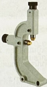
รูปที่ 4.23 ก้านสะท้อนตามและการใช้งาน
