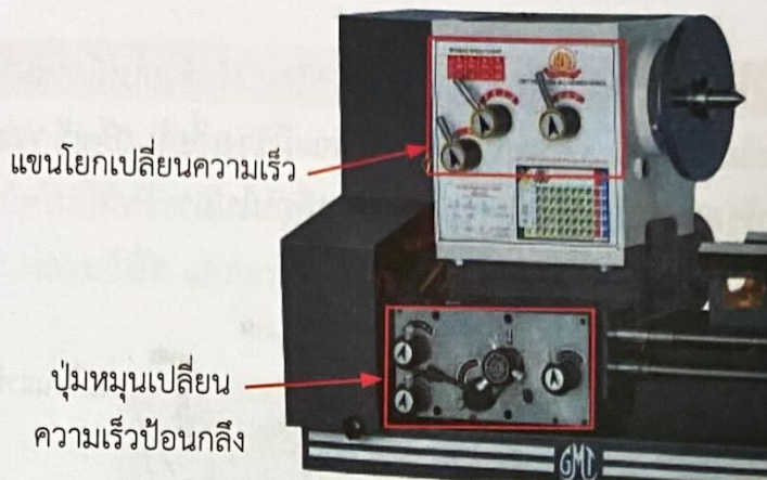
รูปที่ 4.9 แขนโยกเปลี่ยนความเร็วรอบและปุ่มหมุนปรับความเร็วป้อนกลึง
