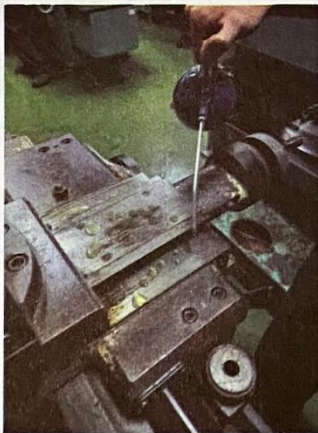
รูปที่ 4.46 หยอดน้ำมันในส่วนที่ต้องหล่อลื่น
