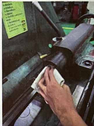
รูปที่ 4.47 ทำความสะอาดอุปกรณ์ต่าง ๆ ก่อนประกอบใช้งาน
